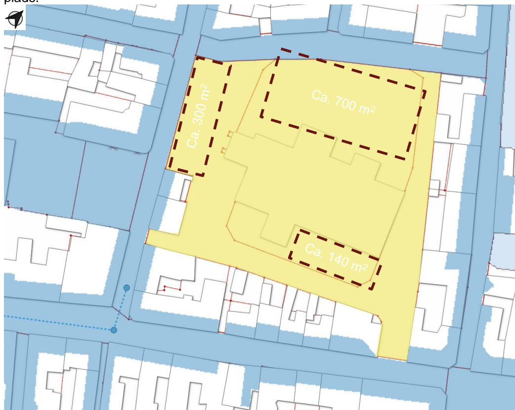
Figur 4-6 Kort over det område ved Sct Olai Kirkeplads og Domkirken, som antages at kunne nedsive (vist med gult). Eventuelle placering af regnbede i de grønne arealer med sort stiplede linje. Matriklen rundt om Domkirkens matrikel er offentlig.
