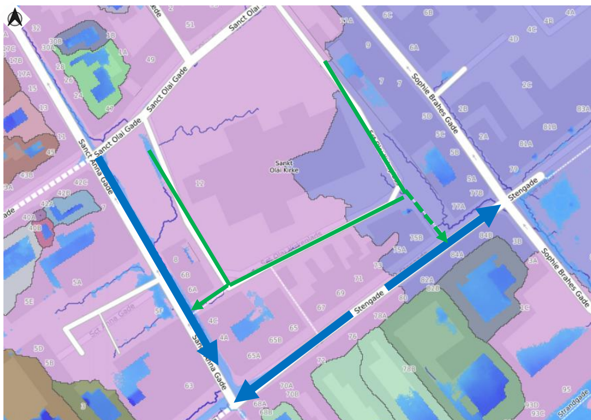
Figur 4-7 Vandoplade for området omkring Domkirken (fra Scalgo). Det nye system med håndtering af regnvand i de omkringliggende gader er vist med blå pile. Forslag til eventuelle grøfter langs med vejen Sct Olai kirkeplads er vist med grønt, hvor den stiplede linje er alternativ ekstra udledning til Stengade.
