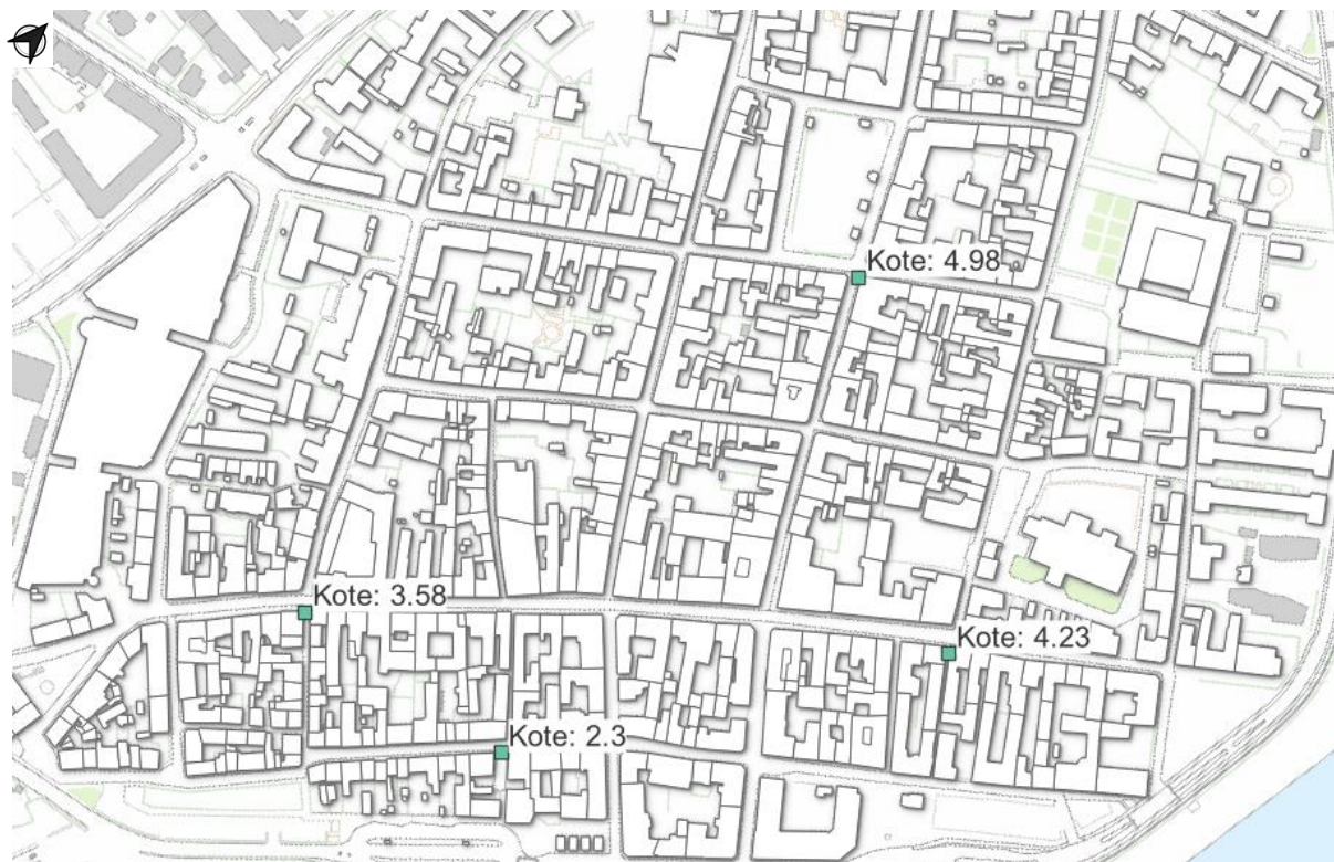
Figur 3-10: Den nødvendige kote for de hydrauliske barrierer til at styre vandet ved en T = 5 års-hændelse. Ved større hændelser må vandet godt løber over de hydrauliske barrierer.
