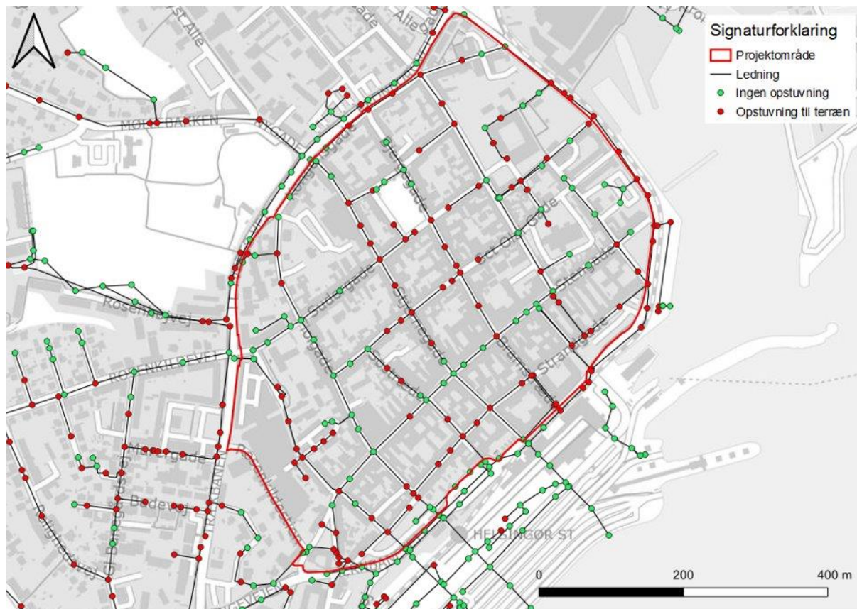
Figur 4-3: Status-beregning for fællessystemet uden sikkerheds- og klimafaktor for T10.
