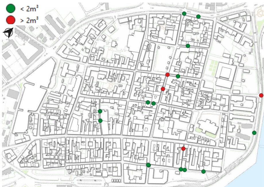
Figur 2-9: Kort over brønde i fællessystemet med opstuvning til terræn ved T = 20 års-hændelse. De røde er med i MIKE FLOOD-modellen, da de har opstuvning større end 2 \text{ m}^3 og de grønne er ikke medtaget.
