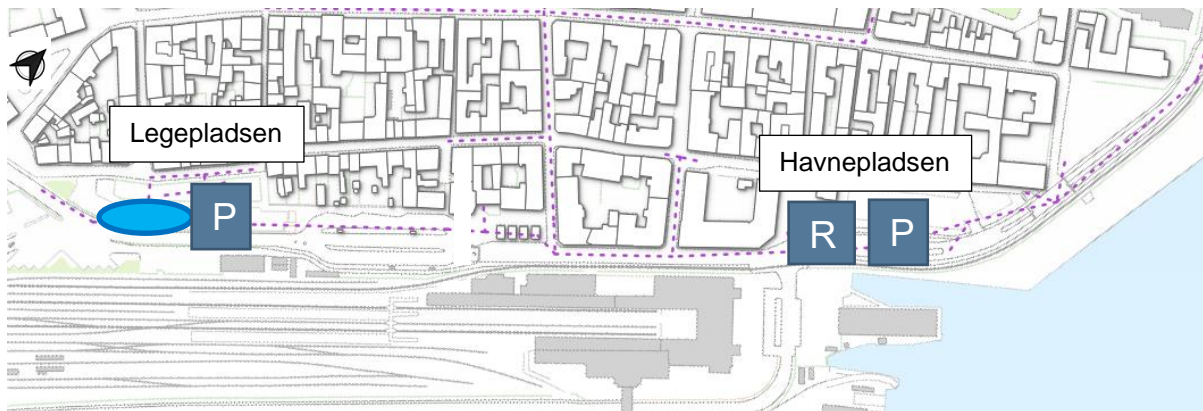
Figur 3-7: Foreslået bassinplaceringer, markeret med blå. Placeringen af pumpestationer (P) og Renseløsning (R) er vist med bogstav i boks.
